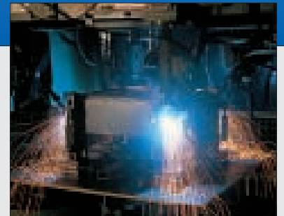
Schweißautomat für Gehäuse-Ecken CNC-welding machines/robotics
